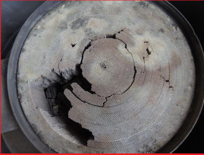
Fotoğraf 3. Aşırı ısıdan dolayı malzeme özelliğini yitirmiş ve kırılmış, parçalanmış SCR.
