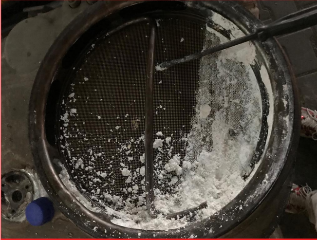
Fotoğraf 1. Standart Dışı AdBlue Kullanımı Sonucu Tıkanmış SCR
